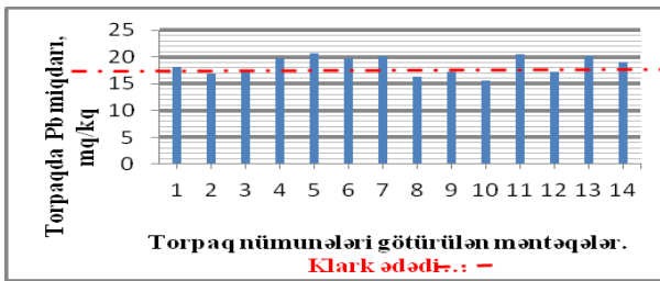
Şəkil 2. Torpaqda qurğuşunun (Pb) ümumi miqdarının fona görə paylanması (Klark, 18,5 mq/kq, QYH 30 mq/kq)
