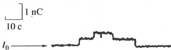
Рис. 7. Запись флуктуаций тока, протекающего через мембрану, при односторонней модификации леворином A_2 . Концентрация антибиотика с одной стороны мембраны 5 \cdot 10^{-8} М. Водные растворы с обеих сторон мембраны содержат 2М КСI, рН 6.5, t=22^{\circ}\text{C} . Мембраны получали в смеси фосфолипида с холестерином в весовом соотношении 20:1. Стрелкой обозначен уровень проводимости немодифицированной мембраны.
