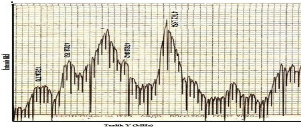
Şəkil 8. Normal propanol - \text{CH}_3\text{CH}_2\text{CH}_2\text{OH} molekulunun “qadağan olunmuş” 8_{36}-9_{28} (47616.770 MHz) və mümkün 8_{35}-9_{28} (47621.854 MHz) keçidlərinə uyğun spektral xətlərin yazılışı.
