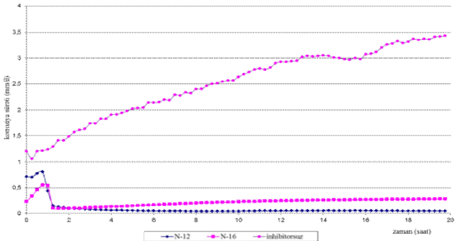
Şəkil 2. N-12, N-16 komplekslərinin 100 mq/l qatılıqda poladı CO_2 korroziyasından mühafizə effekti
