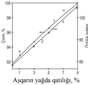
Şəkil 2. Dipoliakiltiofosfinatın qatılığının M-6 yağının özlülük temperatur xassələrinə təsiri
