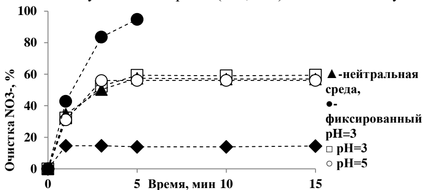
Рисунок 20. Реакции восстановления нитратов биметаллическими наночастицами FeNi при разных рН.
