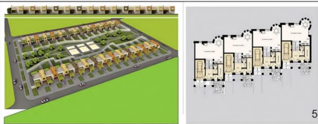
Az mərtəbəli yaşayış evlərinin karkas əsaslı qurulan bloklaşdırılmış evlərinin plan və görünüş həlli
