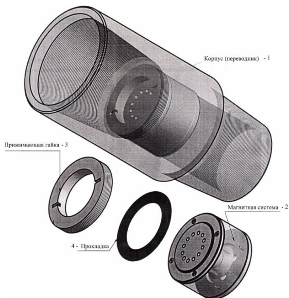
«а»- конструкция обратного клапана; 1-4-соответственно, корпус, магнитная система, прижимающая гайка, прокладка
