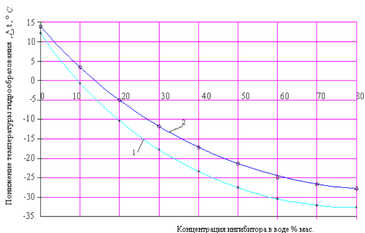
Рис. 2. Зависимости снижения температуры гидратообразования газа от концентрации водных ингибиторов. 1-метанол; 2-изопропиловый спирт
