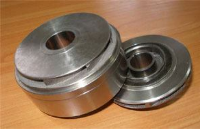
a) Çuğundan hazırlanmış işçi çarx və istiqamətləndirici aparat
