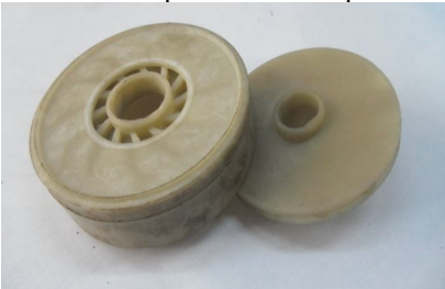
c) Poliamiddən hazırlanmış işçi çarx və istiqamətləndirici aparat
