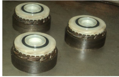
b) İstiqamətləndirici aparat çuğundan və işçi çarxı poliamiddən hazırlanmış pillə
