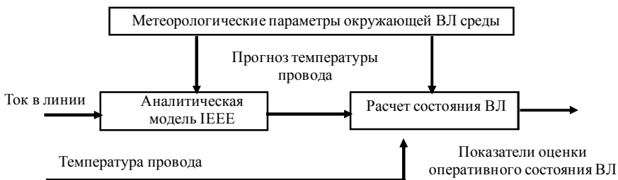
Рис. 8. Оценка состояния ВЛ на основе метеорологических измерений
