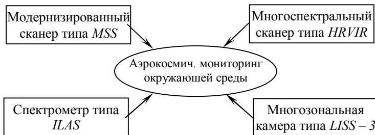
Рис.8. Схема оптимальной комплектации многозональных съёмочных систем, обеспечивающих решение задач АКМОС
