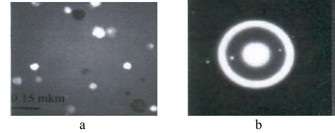
Şək. 6. Ti_{32}Hf_{18}Ni_{35}Cu_{15} ərintisinin termiki emaldan sonrakı (2 dəq, T=496^{\circ}C -də mikroquruluşu (a) və elektron difraksiyası (b).
