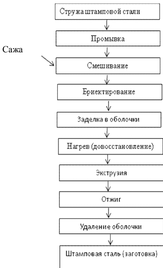
Рис. 1. Технологическая схема получения штамповой стали из стружки
