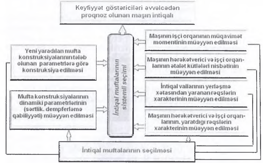
Şək. 3. İntiqal muftalarının seçilməsinə sistemli yanaşma
