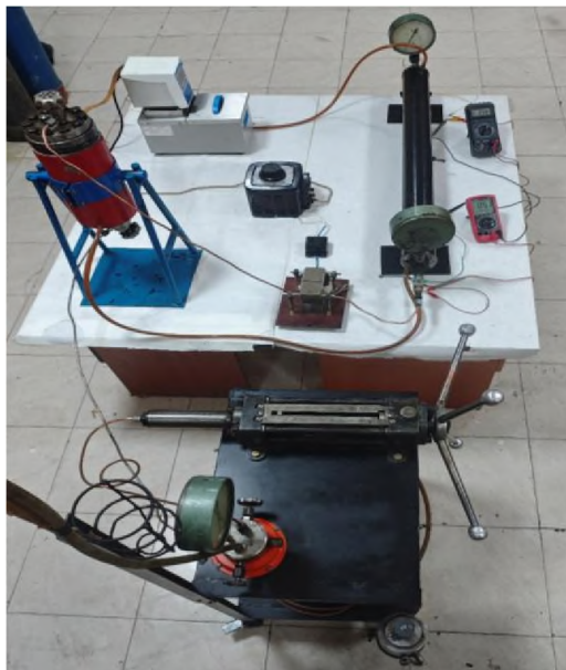
Şəkil 3. Maqnitlənmiş su ilə sıxışdırılmanın təcrübə qurğusunun real təsviri
