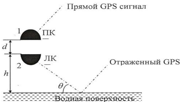
Şəkil 11. Qaytarılmış siqnal metodunun sxematik təsviri.
