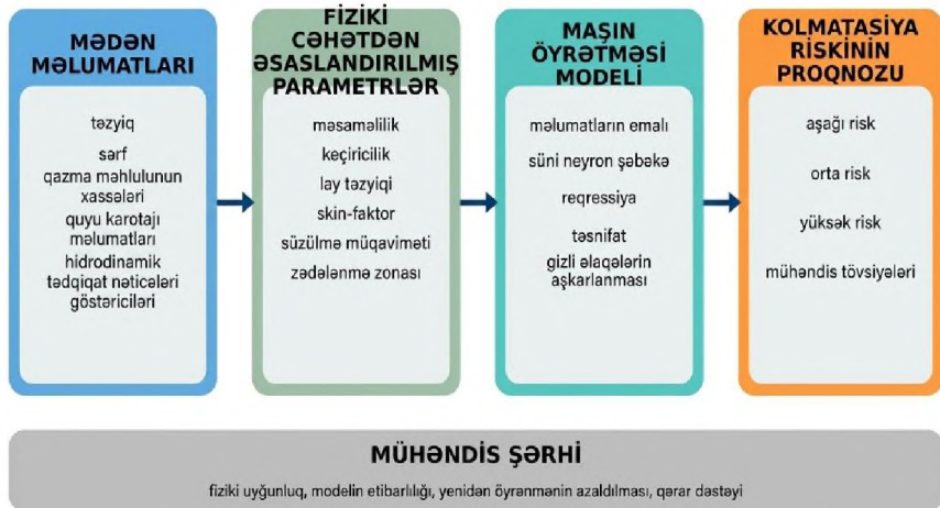
Şəkil 2 – Fiziki parametrlər və mədən məlumatları əsasında kolmatasiyanın hibrid proqnozlaşdırma sxemi
