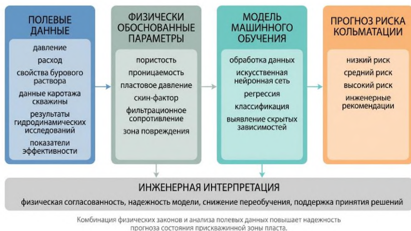
Рисунок 2 – Гибридная схема прогнозирования кольматации на основе физических параметров и промысловых данных
