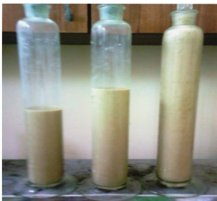
Şəkil 1. Tərkibi (25 % TYTN + 75 % MLSP–R) olan MKT reagentinin məhlulda miqdarının mikroköpük yaratma effektivinə təsiri: a, b, c reagentin məhlulda quru kütlə üzrə miqdarı, uyğun olaraq - 1 %, 2 %, 3 %
