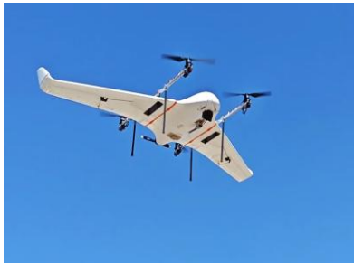
Şəkil 12. VTOL tipli pilotsuz mikro uçuş aparatının VTOL və təyyarə uçuş rejimlərində aparılan praktiki sınaq uçuşları
