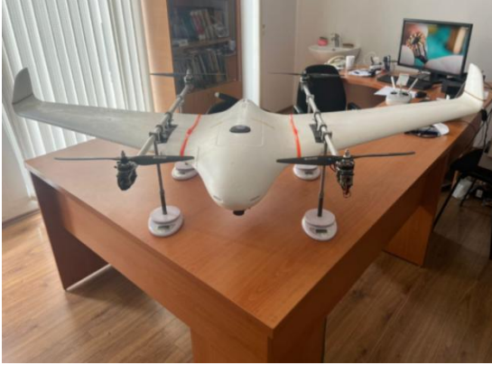
Şəkil 10. VTOL tipli PUA-nın AM-nin təyin olunması məqsədi ilə laboratoriyada hazırlanmış işçi yer
