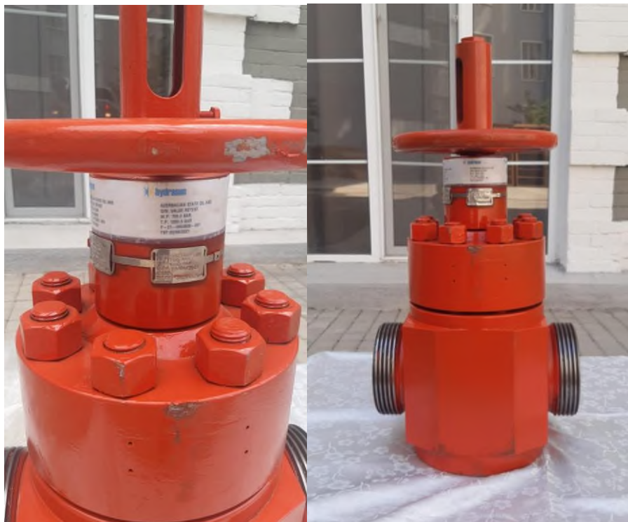
Şəkil 3. Hazırlanmış MMS 100x70 tipli siyirtmənin ümumi görünüşü
