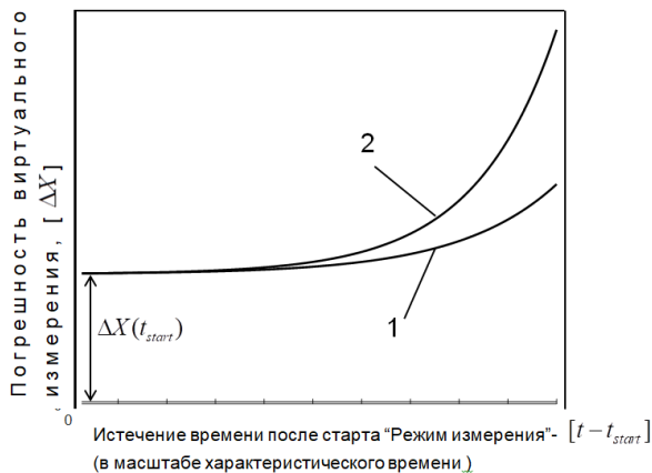
Рисунок 7. Характер влияния рассинхронизации «модель-объект» на точность виртуального измерения
