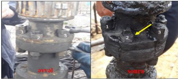
Şəkil 19. MEDN 5-25-500 markalı dərinlik nasosunda nanoörtüyün tətbiqi (1, 3 – nanoörtüklü, 2 – adi örtüklü sancaq və qaykalar)
