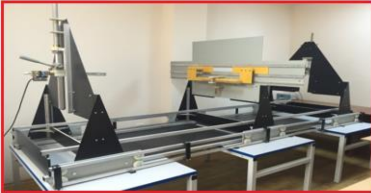
Şəkil 6. İstiqamətlənmə diaqramının eksperimental təyini üçün işlənib hazırlanmış qurğu
