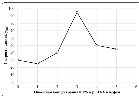
Рисунок 1. Зависимость реологического поведения нефти от концентрации водорастворимого полиакриламида (ПАА)
