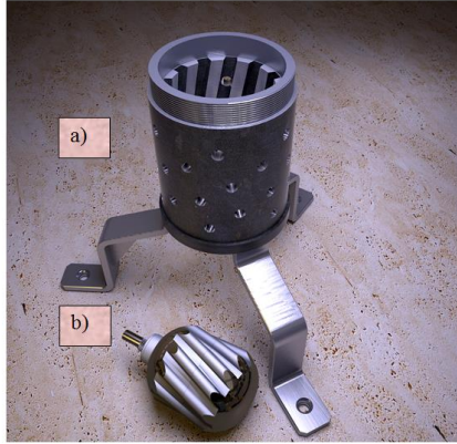
Şəkil 6. Viskozimetrik qurğunun sensor elementləri: a) stator, b) rotor
