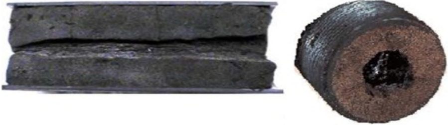
Şəkil 12. Neft kəmərlərində yaranmış QAPÇ-in yaratdığı ştatdankənar kavitasiya zonası
