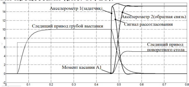
Рис. 19. Кривые, полученные от симуляции компьютерной модели СУ АСНВА
