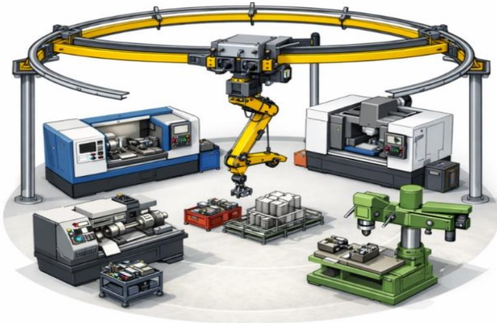
Şəkil 4. Çevik istehsal sahəsində sənaye robotunun bir neçə dəzğaha xidmət edən modulun 3D quruluşu
