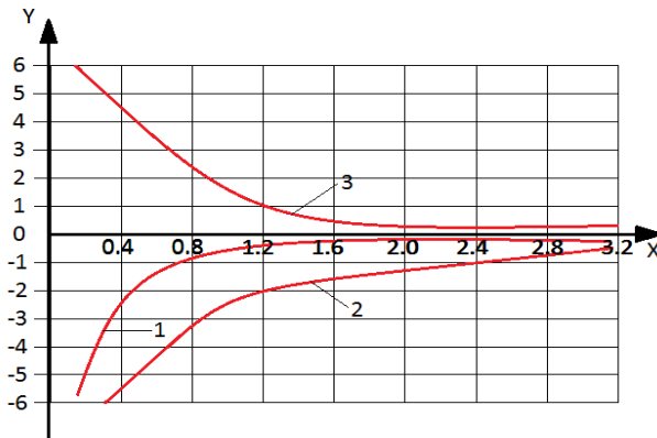
Qrafik 11. Silindrin radial gərginliklərinin ( y = \sigma_{rr} ) “x” parametrindən ( \frac{x_1}{x_0} nisbətinin müxtəlif qiymətlərində) asılı olaraq dəyişməsi
