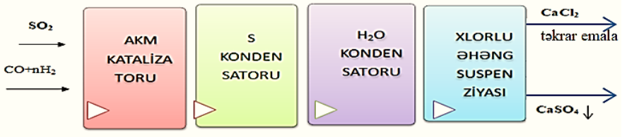
Şəkil 3 SO 2 -nin konversiya qazı ilə reduksiyasından sonra qalan qaz qarışığının (H 2 S, SO 2 , N 2 , CO 2 ) xlorlu əhənglə udulmasının prinsiplial texnoloji sxemi
