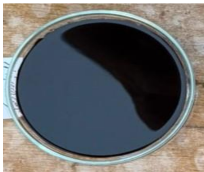
Şəkil 3. İPS + Dizel distillatının nitrolaşma məhsulu + TNT-nin Fe duzu kompozisiyasının suyun səthindən Salyan neftini yığıma qabiliyyəti.
