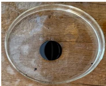
Şəkil 3. İPS + Dizel distillatının nitrolaşma məhsulu + TNT-nin Fe duzu kompozisiyasının suyun səthindən Salyan neftini yığıma qabiliyyəti.
