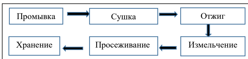
Рис. 7. Диаграмма технологического процесса приготовления присадки для контроля потери жидкости
