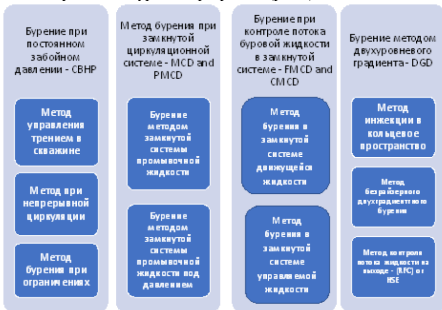
Рис.8. Категории и подкатегории производства буровых работ при управляемом скважинном давлении
