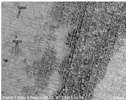
Şəkil 2. Bis-imidazolin iştirakında korroziya gedən səthin: a) 100 dəfə böyüdülmüş, b) 250 dəfə böyüdülmüş görünüşü
