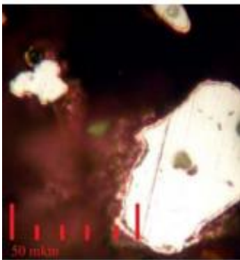
Рисунок 27. СЭМ изображения микрошлифа композиционного материала «железо-чугун-стекло»: (20%.мас. медненный чугун, 4%.мас. медненное стекло и остальное железо, (а) P=1000 МПа, t_{\text{спек.}}=1150 °С, \tau_{\text{спек.}}=1 ч.) и расположение микрошлифов на рабочем столе СЭМ (б)
