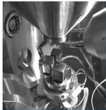
Рисунок 27. СЭМ изображения микрошлифа композиционного материала «железо-чугун-стекло»: (20%.мас. медненный чугун, 4%.мас. медненное стекло и остальное железо, (а) P=1000 МПа, t_{\text{спек.}}=1150 °С, \tau_{\text{спек.}}=1 ч.) и расположение микрошлифов на рабочем столе СЭМ (б)
